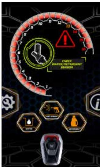
2 Überprüfung von Wasser- und Reinigungsmittelsensoren erforderlich
