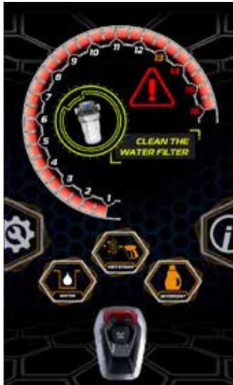
1 Reinigung des Wasserfilters erforderlich
