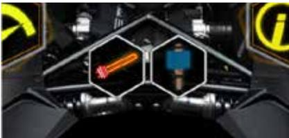
Wenn die Wasserpumpe oder das Heizelement in Betrieb ist, leuchtet die entsprechende Anzeige auf.
