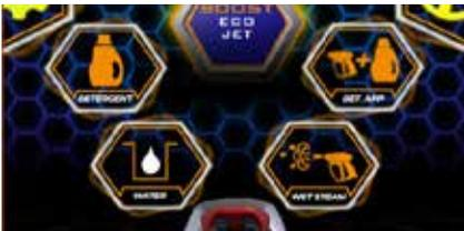
Die weiße Farbe der Wasseranzeige und die orangefarbene Reinigungsmittelanzeige 1 bedeuten einen ausreichenden Flüssigkeitsstand.
