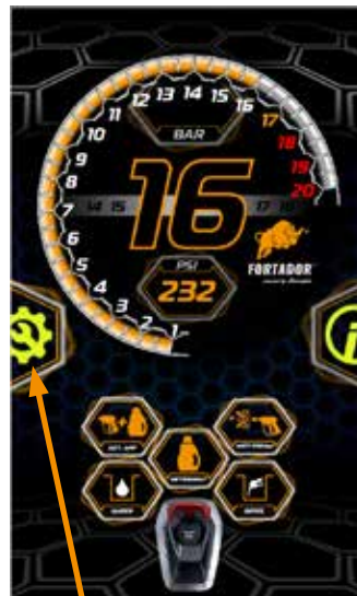
Taste zum Starten der Wasserpumpe im Servicemodus
