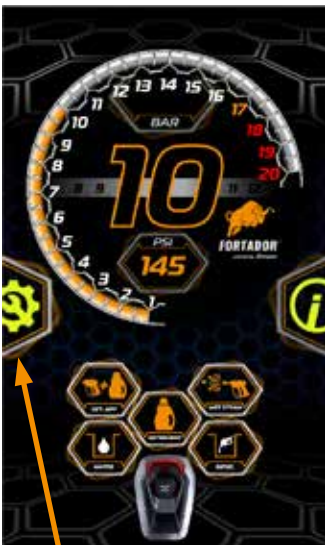
Taste zum Starten der Wasserpumpe im Servicemodus
