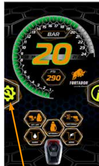
Taste zum Starten der Wasserpumpe im Servicemodus
